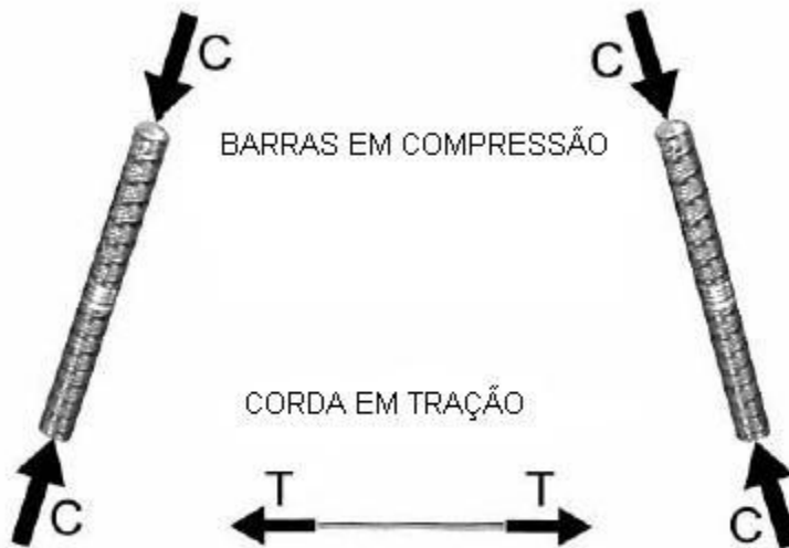
Figura 9: Exemplo de corpo sofrendo tração e compressão
