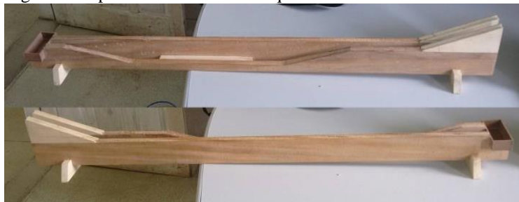
Figura 2: Experimento similar a braquistócrona
